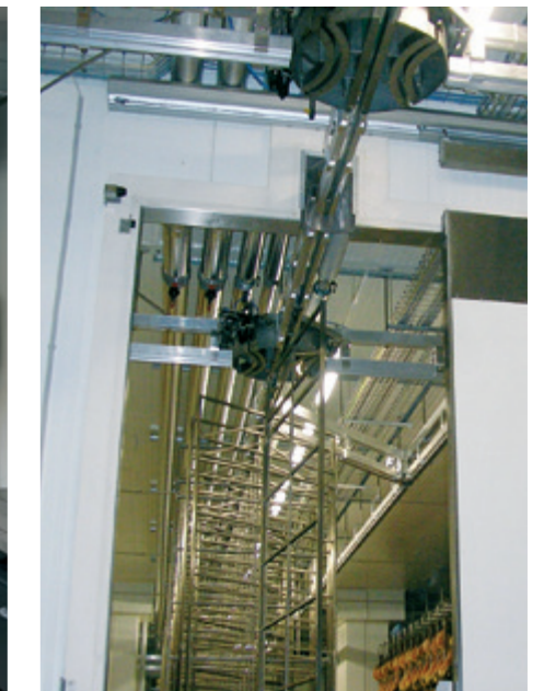
Soluzioni varie con feritoia per passaggio guidovia Special overhead rail and "swan neck" passage Schiebetür mit Ausschnitt für Hängebahn (Typ Schwanenhals)
